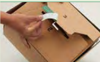
Bodenlaschen nach innen, Verschlusslaschen mit progress-Selbstklebeverschluss verkleben
