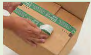
den zur anlenkenden Außenseite angebrachten Abdeckstreifen abziehen ...
