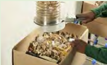
Die ergonomisch geformte Abfüllzange ermöglicht ermüdungsfreies Verfüllen.
