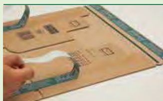
Silikonabdeckband an der Deckelklappe abziehen
