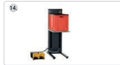
Pneumatik-Hublift, Plattform aus Edelstahl • Plattform aus Edelstahl BxT 450x600mm • Hub 500 mm bzw. 700 mm • inkl. Fußtaster • Tisch mit Fußgrundgestell • erfordert Druckluftanschluss von 6 bar • max. Flächenlast 60 kg • max. Hubgeschwindigkeit 160 mm/sec.
