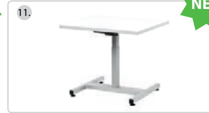
Stationärer Elektro-Hubtisch • Höhenverstellung durch Elektromotor • mit drei Speicherpositionen der Arbeitshöhe • max. Flächenlast 60 kg • max. Hubgeschwindigkeit 38 mm/sec.
