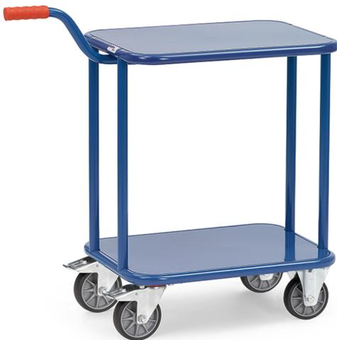
Aus Stahlrohr geschweißt mit Stahlblechplattform. 2 Plattformen mit bündig eingeschweißtem Stahlblech 2 mm stark, pulverbeschichtet brillantblau RAL 5007. Griff anschraubbar. 2 Lenk- und 2 Bockrollen, TPE-Bereifung (spurlos), Naben mit Rillenkugellager, Feststeller an den Lenkrollen, gemäß der Europäischen Norm EN 1757-3 (Sicherheit von Plattformwagen). Tragkraft obere Ladefläche 100 kg.
