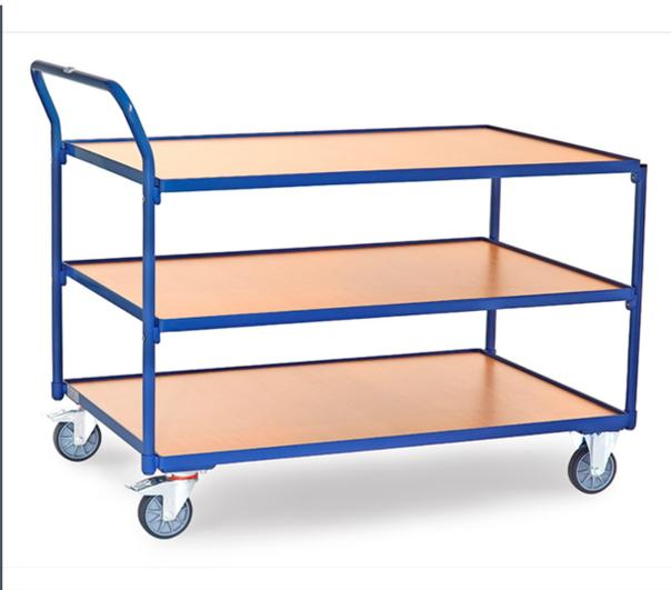
Leichter Tischwagen aus Stahlrohr und Profilstahl geschweißt, pulverbeschichtet brillantblau RAL 5007. Schraubkonstruktion. 3 Böden aus Holzwerkstoffplatte, Oberfläche Buchendekor, im Stahlrahmen liegend mit 12 mm hohen Rand. Schiebegriff hochstehend. 2 Lenk- und 2 Bockrollen, TPE-Bereifung, Naben mit Rillenkugellager. Feststeller an den Lenkrollen, gemäß der Europäischen Norm EN 1757-3 (Sicherheit von Plattformwagen). Tragkraft obere und mittlere Ladefläche 80 kg.
