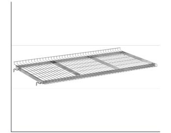
Etagenboden aus Drahtgitter 120 x 30 mm, galvanisch glanzverzinkt. An einer Längsseite 23 mm nach oben, an der anderen 23 mm unten abgekantet. Im Raster von 100 mm waagerecht oder geneigt einhängbar. Tragkraft pro Boden 80 kg
