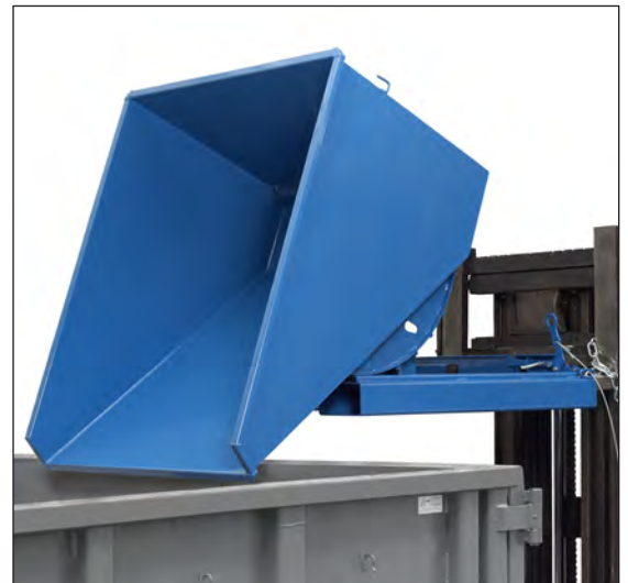
Selbstkipper als Schrottbehälter mit Gabelstapler
